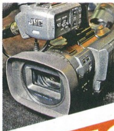
內置 F2.8 大光圈鏡頭，支援 10 倍光學變焦，等效焦距相當於 42.4-424mm。
